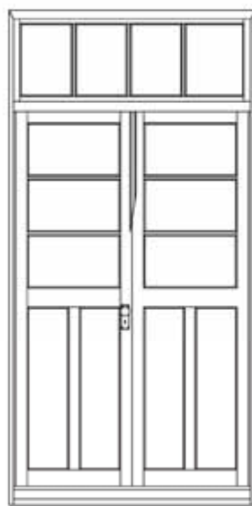
圖 5-8 現況中央通廊雙開門
