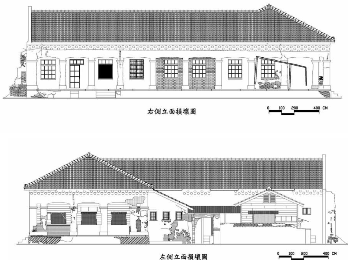
圖 6-3 外牆立面損壞圖
