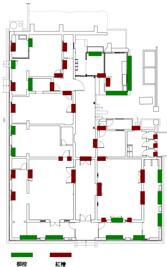
圖 4-45 水產試驗場室內門窗之木材使用
