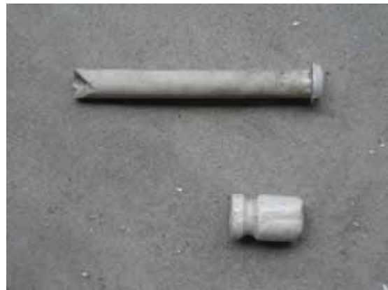
照片 4-89 礙子及瓷製導線管
