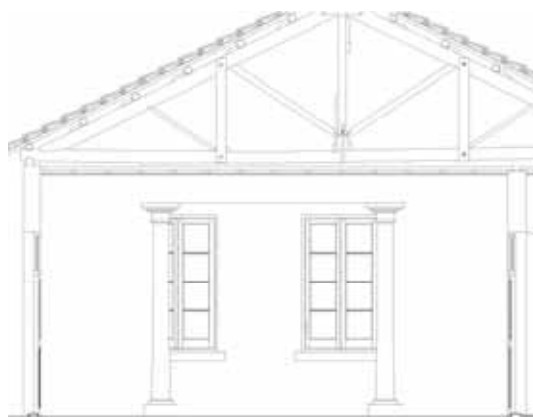
圖 5-12 中央通廊西側牆面復原
