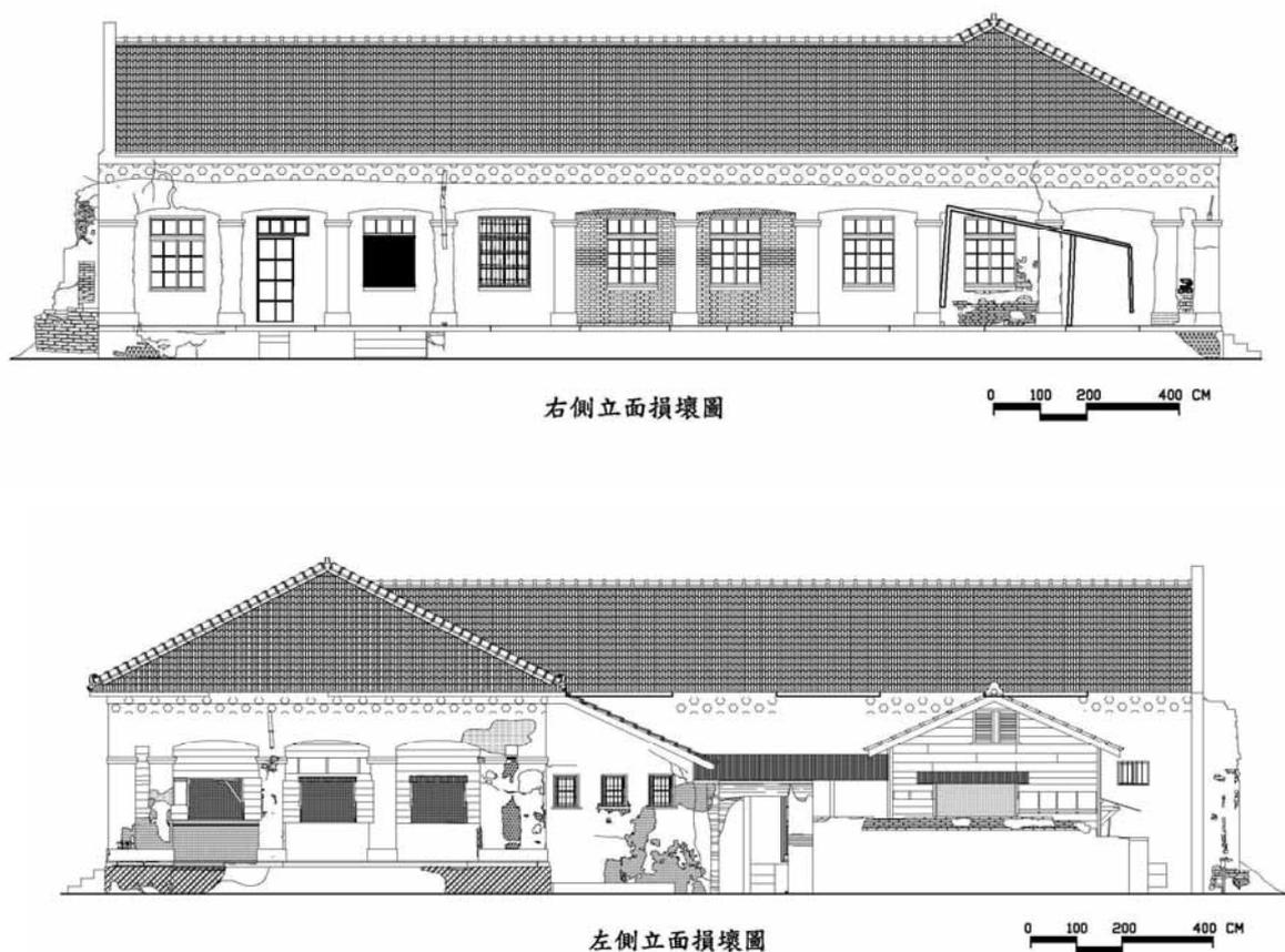
圖 6-3 外牆立面損壞圖
