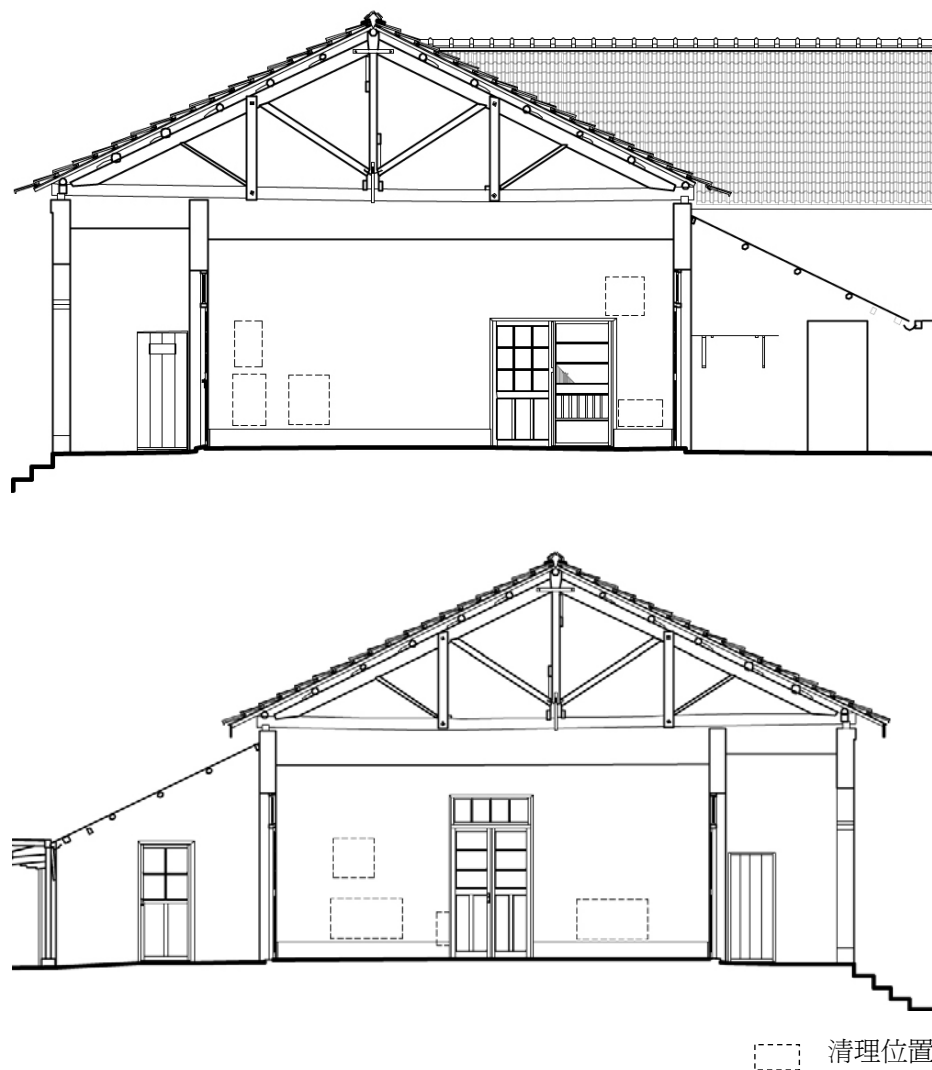
圖 3-9 中央通廊東西壁面清理位置
